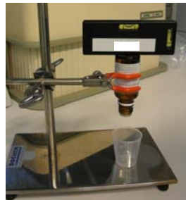
Abbildung 1: senkrecht eingespannte Tropfflasche zur Ermittlung der Dosiergenauigkeit.
