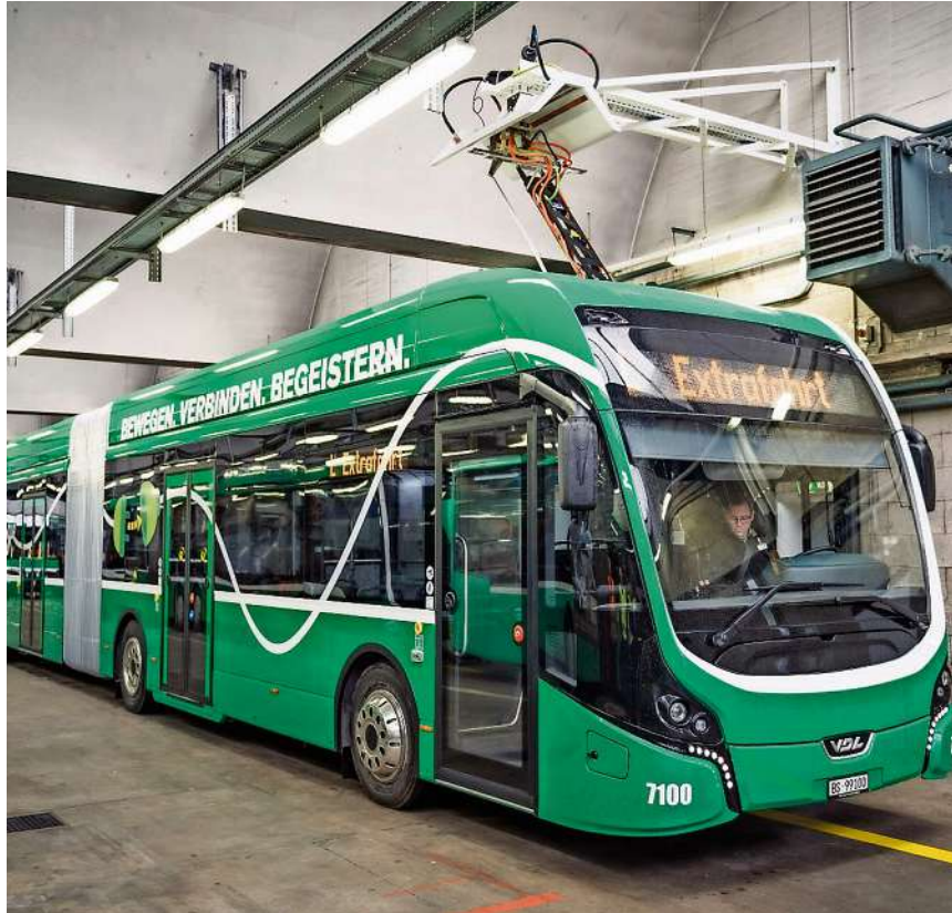
Drei Tonnen Batterien. Der 800 000 Franken teure Dreiaxler von VDO tankt in der Garage Rank Strom für maximal 130 Kilometer Fahrt. Foto Florian Bärtschiger
